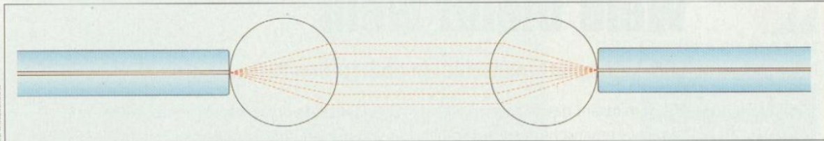
Grafische Darstellung der Funktionsweise eines Linsensteckers: Beim Auftreffen auf eine gegenüberliegende Kugellinse fokussiert diese den Lichtstrahl wieder auf die Faser.
